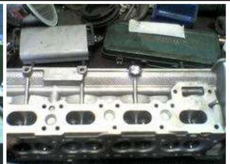
Auch auf dieser Seite wurde Material für eine zusätzliche Befestigungsmöglichkeit für das Dual-Ram-Geweh aufgetragen.
