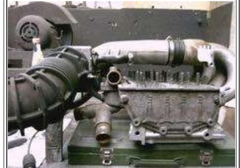
Der Wasseranschluß behindert den Ventildeckel, den Abtrennen und um ca. 20° verdreht erneut anschweißen, oder eine Adapterplatte bauen und dazwischen bauen, so werde ich das machen...
