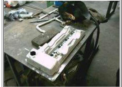
Das Thermostatgehäuse liegt auf dem Brenner zum Vorheizen. Der Flansch am Gehäuse ist schon eingekürzt & angepunktet. Das hintere Bild zeigt es Fertig verschweißt.
