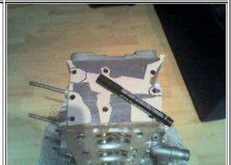
Die Löcher in die Verschlussplatte bohren.
