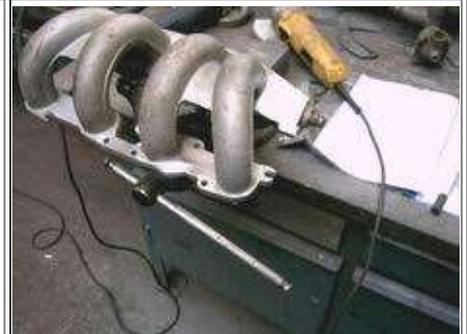
Das Ansauggeweiß ist fertig verschweißt und geschliffen. Der Ventildeckel wird aufgespannt und fixiert und dann geheftet.
