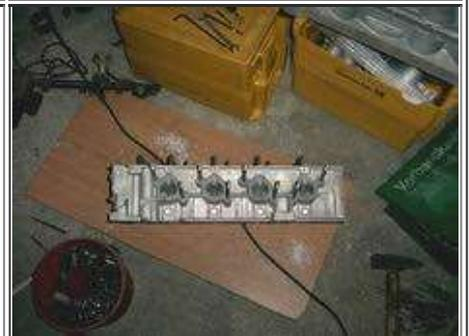
Die Halterungen und das Thermostatgehäuse sitzen zur Probe.
