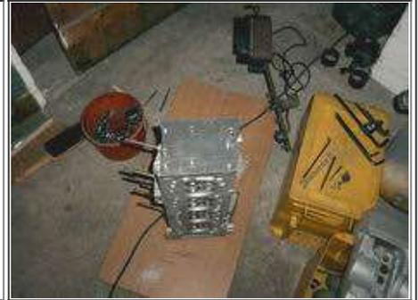
Die Dichtfläche am Kopf wird später mit einem hitzebeständigen Silikon eingeschmiert so wie es beim Thermostatgehäuse Verwendung findet. Die Schrauben setze ich mit hochfestem Schraubensicherungslack ein (DANKE an [Fa. Schrasitec](#)).
