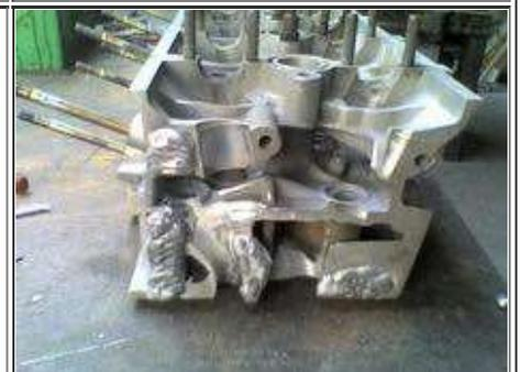
Eine Trennwand um den Wasserkanal vom Ölkanal zu trennen wurde eingeschweißt.
