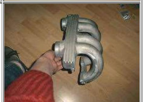
Geweih passen unten auf Antrieb 2 Schrauben, die anderen Löcher müssen dezent zu Langlöchern umgebohrt werden und 2 Löcher müssen gänzlich neu konstruiert werden.
