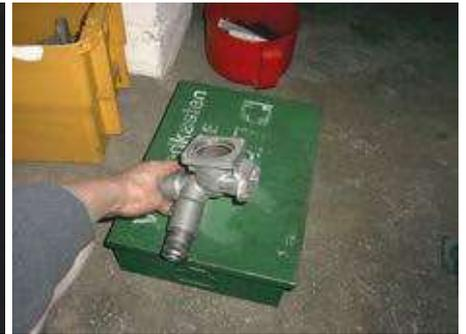
Das Thermostatgehäuse passt nicht zwischen Kopf und Drosselklappe, deshalb habe ich den Flansch abgetrennt und weiter innen wieder anschweißen lassen. Das Loch für den Temperaturfühler muß neu gebohrt werden. Der Deckel für das Thermostat muß auch umgebaut werden.
