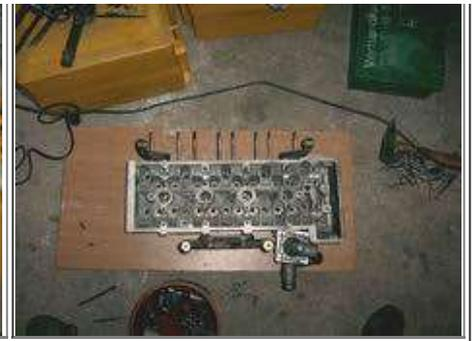
Der Kopf ist fertig, einmal ALLES probemontieren bevor es zur nächsten Bearbeitungsstufe geht.
