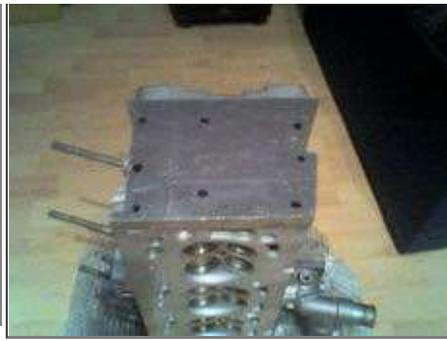
Anschließend die Löcher von der Verschlussplatte auf den Kopf übertragen und ebenfalls bohren. In die Bohrungen im Kopf werden Gewinde eingeschnitten. Die Löcher in der Verschlussplatte werden noch eingesenkt damit die Schraubenlöcher verschwinden. Als Schrauben sind wohl Imbus-Schrauben ideal...
