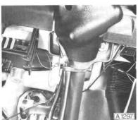
Anschluß der Schalterklemme "58" am Sicherungskastenanschluß "B" .
