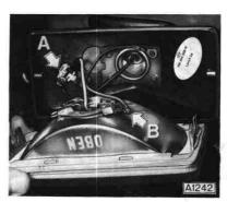
Kabel von Klemmen "86" und "30" des Nebelscheinwerfer-Relais am Kabelsatz Abblendschalter und am Kabelsatz Lichtschalter anschließen.
