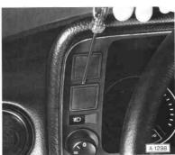
Elektrisch angeschlossenen Nebelschlußleuchtenschalter in Instrumentenblende einsetzen.
