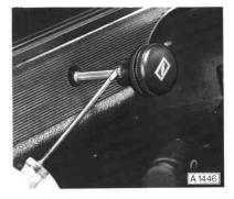
Schalter bzw. Abdeckung der Schalteröffnung rechts und links aus Schalterleiste herausziehen.
