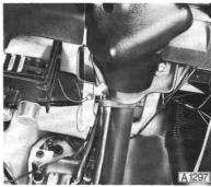
Anschluß der Schalterklemme "58" am Sicherungskastenanschluß "B".
