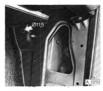
Lampenträger mit Unterlage an beide Kotflügel anschrauben. Glühlampe einsetzen.
