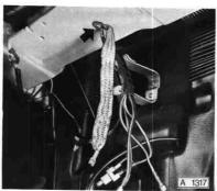
Glühlampe in Fassung und Fassung in Fassungshalter einsetzen.
