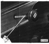
Schalter bzw. Abdeckung der Schalteröffnung rechts und links aus Schalterleiste herausziehen.
