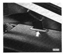
Gurthalterungen am Radeinbau und Bodenblech anschrauben.
