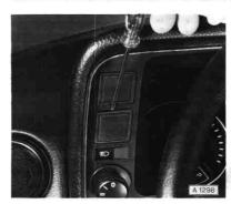
Nebelschlußleuchten-Zuleitung durch Rückwand in Nebelschlußleuchte führen und anschließen. Glühlampe einsetzen.
