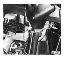
Schalterleiste, linke Instrumententafelverkleidung und Deckel über Sicherungskasten wieder montieren.
