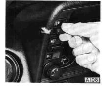
Mehrfachstecker vom Nebelscheinwerferschalter abziehen.
