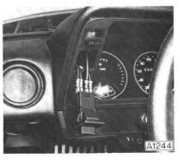
Massekabel des Schalters an der Zentralmasseschraube mit anschrauben.
