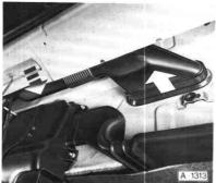
Vom linken Gewindebolzen der rechten Entfrosterdüse Sechskantmutter und Scheibe entfernen.
