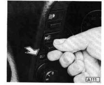
Mehrfachstecker vom Nebelschlußleuchtenschalter abziehen.
