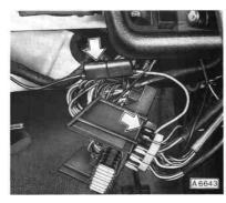
Instrumententafelverkleidung, Schalterleiste und Sicherungskastendeckel einbauen.
