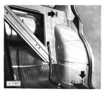
Hutablage an der Vorderseite lösen und am Befestigungspunkt für den oberen Haltegurt 2 Unterlagscheiben (dünn) des Einbausatzes sowie 2 Unterlagscheiben, je 9 mm stark, Katalog-Nr. 3 10 710, zwischen Hutablage und Blech legen. Hutablage wieder befestigen.
