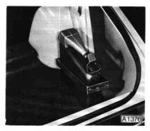
Reservekanister-Halter an rechter Seitenwand innen mit 2 Schrauben anschrauben. Hierzu 2 Löcher in Halter und 2 Löcher in Seitenwand innen Ø 6,2 mm bohren.
