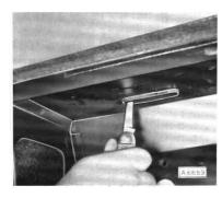
In linke und rechte Seitenwand Verstärkungsplatte einsetzen. Platten mit je 2 Blindnieten befestigen.
