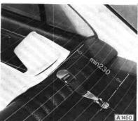
Befinden sich im Fahrzeug bereits Rücksitz-3-Punkt-Sicherheitsgurte, so kann der Kindersitz auch mit diesem Gurt und dem am Kindersitz befindlichen oberen Haltegurt befestigt werden.
