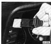
Zum Ersatz der Symbolbeleuchtungs-Lampe ist die Leuchtenfassung mit Lampe nach hinten aus dem Schalter herauszuziehen.
