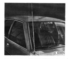
Antennenloch Ø 18,5 mm entsprechend den angeführten Maßen bohren. Auf der Kotflügelunterseite Anlagefläche der Antenne gut blankschaben.
