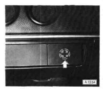
Deckel über Sicherungskasten abnehmen.
