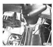
Rotes Kabel "30" der Steckdosen-Klemme "54 g" mit Kabelsicherung am rechten hinteren Service-Stecker anschließen.
