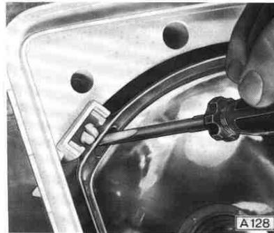
Reflektor-Gummitülle aus Führung des Scheinwerfergehäuses herausdrücken.
