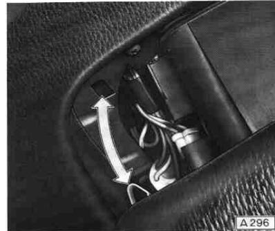
Instrumentengehäuse – Glas mit Rahmen ausbauen. Hierzu rechts und links je zwei Blechschrauben abschrauben.
