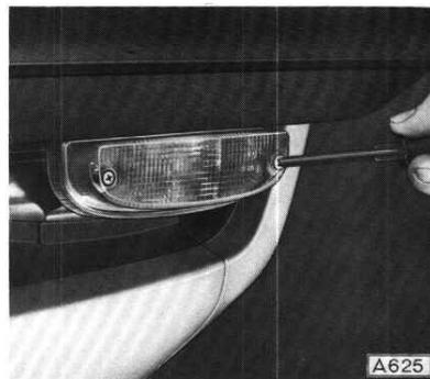
Leuchtengehäuse vom Kotflügel abschrauben.
