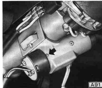
Mehrfachstecker »C« des Kontaktteilkabelsatzes
