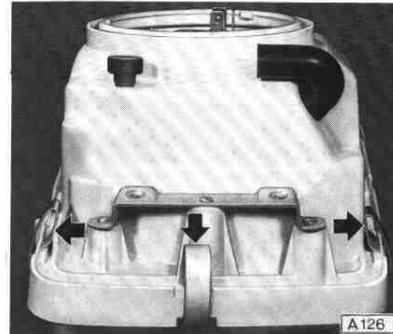
Glasdichtung und Lichtscheibe der vorderen Blinkleuchte abnehmen.
