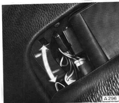
Instrumentengehäuse – Glas mit Rahmen ausbauen. Hierzu rechts und links je zwei Blechschrauben abschrauben.
