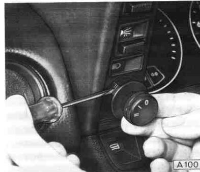
Mehrfachsteckdose nach hinten vom Licht- und Innenraumleuchtenschalter abziehen.
