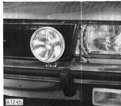
Befestigungslöcher für beide Fernscheinwerferhalter auf Stoßfänger anreißen.
