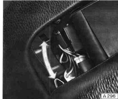
Instrumentengehäuse – Glas mit Rahmen ausbauen.
