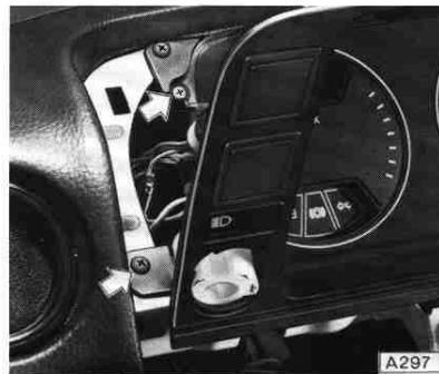
Beide Heizungsbedienungshebel nach vorn abziehen.
