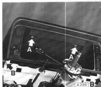
Die Hutze ist an der Instrumententafel durch zwei Klammern zusätzlich gehalten.
