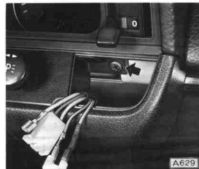
Instrumentenhutze ausbauen. Hierzu zwei Blechschrauben »A« an der Hutzeninnenfläche und zwei Blechschrauben »B« an der Instrumententafel abschrauben. Zur besseren Darstellung ist das Lenkrad ausgebaut.
