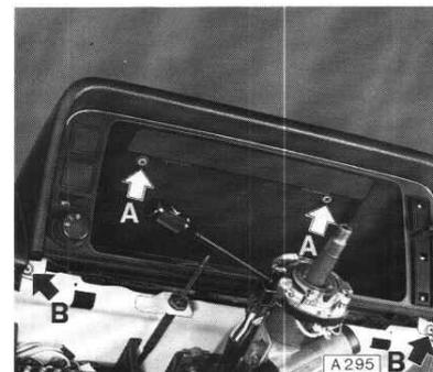
Die Hutze ist an der Instrumententafelpolsterung durch zwei Klammern zusätzlich gehalten. Klammern lösen und Instrumentenhutze abnehmen.
