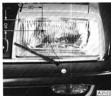
Bei einem evtl. Ersetzen der vorderen Stoßstange bei Manta-B sind die Löcher für die Montage der Spritzdüsen auf dem Neuteil nach den Angaben in Bild A 2123 zu bohren. Lochränder entgraten und mit Klarlack streichen.
