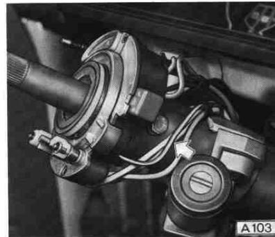
Schleifkontaktgehäuse mit Schraubenzieher
