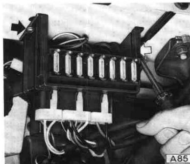
Seitliche Rastennasen an den Sicherungshaltern bebiegen und Halter aus Sicherungskasten nach hinten herausziehen.
