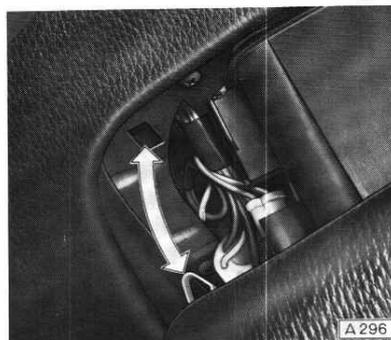
Instrumentengehäuse – Glas mit Rahmen ausbauen.
