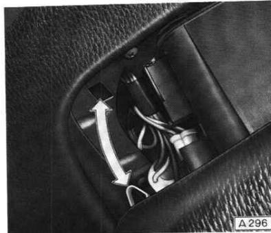
Instrumentengehäuse – Glas mit Rahmen ausbauen.
