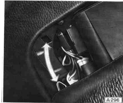
Instrumentengehäuse – Glas mit Rahmen ausbauen. Hierzu rechts und links zwei Blechschrauben abschrauben.
