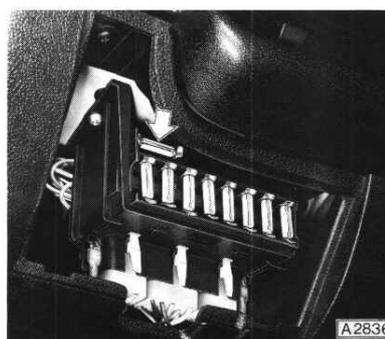
Anordnung der 8-Ampere-Sicherung für die Scheinwerfer- und Scheibenwisch- und -waschanlage.
