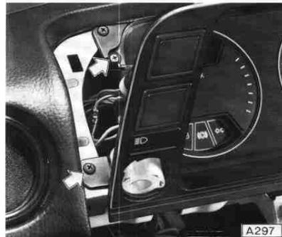
Beide Heizungsbedienungshebel nach vorn abziehen.
