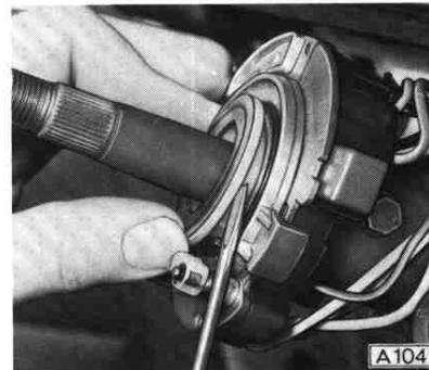
Sprengring vom Signalschalter demontieren.
