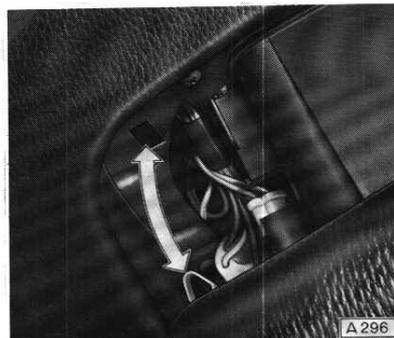
Instrumentengehäuse – Glas mit Rahmen ausbauen.
