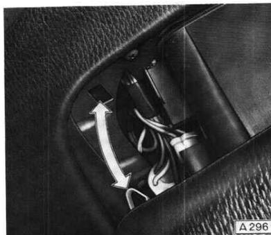
Instrumentengehäuse – Glas mit Rahmen ausbauen. Hierzu rechts und links zwei Blechschrauben abschrauben.
