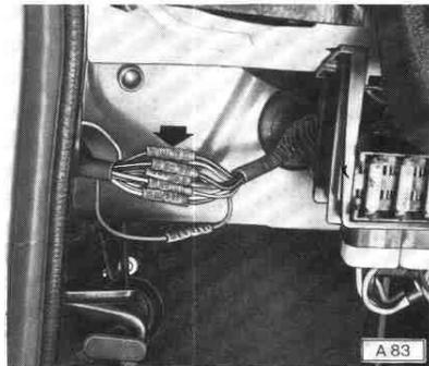
Vorderen Teil des Kabelsatzes mit dem hinteren Teil mittels Kabelverbinder verbinden. Auf farbgleichen Anschluß der einzelnen Kabel achten.
