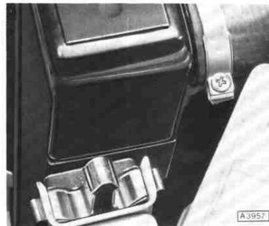
Die Klammern können durch Zusammendrücken entfernt werden.
