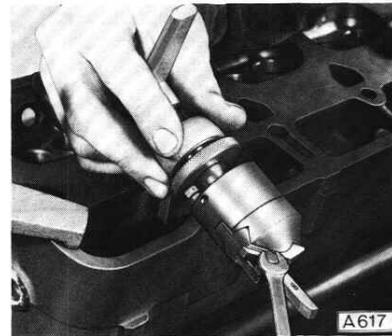
Support so einrichten, daß die Stahlspitze in der Mitte der 45°-Ventilsitzfläche aufliegt.
