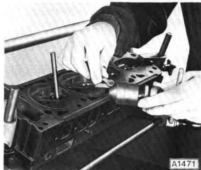
Support so einrichten, daß die Stahlspitze in der Mitte der 45°-Ventilsitzflächen aufliegt.
