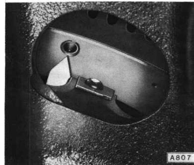
19 E-Motor: Kerbe auf der Riemenscheibe zeigt auf Markierung (langer Balken) auf dem Steuergehäuse.
