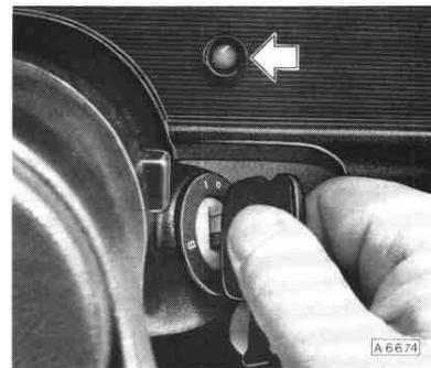
Gleichzeitig leuchtet in der Instrumententafel eine rote Lampe auf (Bild A 6674), die nach Beendigung des Vorglühvorganges erlischt.
