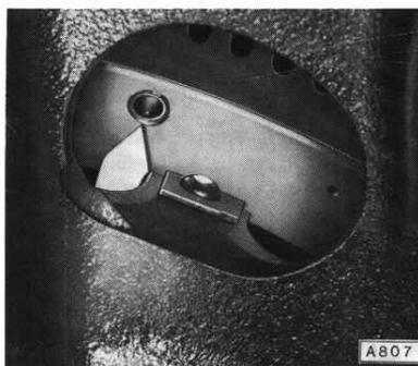
Klemmschraube am Verteiler lösen und Zündzeitpunkt einstellen. Hierbei müssen Zeiger im Schauloch des Motorblockes und Kugel im Schwungrad fluchten.
