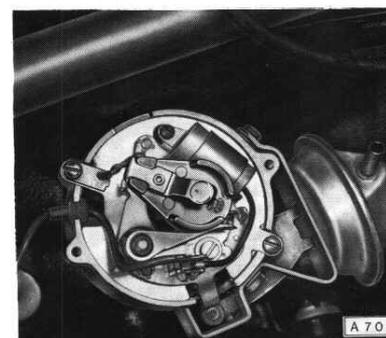
Um den Einbau des Verteilers zu erleichtern, soll die Grundeinstellung der Ölpumpe erhalten bleiben.
