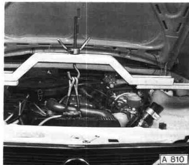
Dämpfungsblock mit Motordämpfungsblock-Montageschlüssel KM-207 (OHV-Motor) bzw. KM-127 (CIH-Motor) vom Achskörper abschrauben und auswechseln. Auf Anschlagtopf achten. Motor ablassen und Motorbefestigung rechts und links mit 40 Nm (4 kpm/29 ft. lbs.) festziehen.
