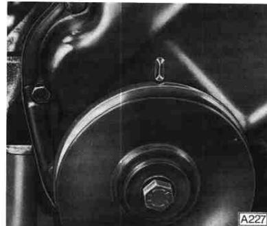
Ventilspiel vom Aus- und Einlaßventil des 1. Zylinders sowie Einlaßventil des 2. Zylinders und Auslaßventil des 3. Zylinders einstellen.
