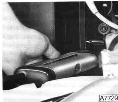
Klemmlasche (Pfeil) am Verteiler lösen und Zündzeitpunkt durch Drehen des Zündverteilers korrigieren.
