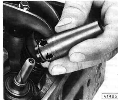
Bild zeigt richtig montierte Ventilschaftabdichtung.
