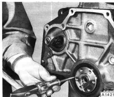
Entsprechend der geschlagenen Lochgröße eine passende Blechschraube eindrehen und mit einer Beißzange, auf unterem Zylinderblocksteg abstützend, Wellendichtring aus Sitz herauskanten.
