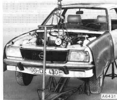
In Haken von Motorheber KM-252 einhängen und Motorheber an vorhandenem Hebegerät befestigen.
