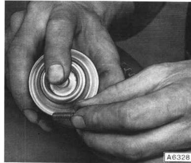
Stützplatte anschrauben. Kupplungsseil einhängen. Motormasseband befestigen. Auspuffrohr an Krümmer anschrauben. Vorderachse einbauen (siehe dazu Arbeitsvorgang in Gruppe E). Hierbei ist darauf zu achten, daß die Arretierung richtig sitzt (Pfeil).
