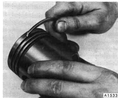
Als Ölabbstreifring wird bei den 16-, 16 S- und 19 S-Motoren ein PC-Ring verwendet. Der Ölabbstreifring des 19 E-Motors ist ein „Dachfasenring mit Schlauchfeder“.
