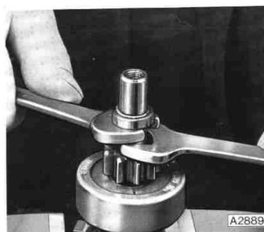
Anlasser auf Prüfstand oder im eingebauten Zustand prüfen.
