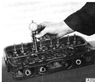
Das Ausreiben der Führung sollte immer von der Außenseite erfolgen, damit die maßgenauere Bohrung auf der Kegelseite der Ventile liegt. Maße der Ventilschaftbohrungen siehe Tabelle auf Seite 139.
