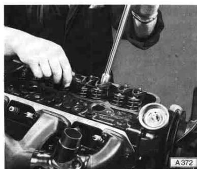
Kurbelwelle eine volle Umdrehung weiterdrehen. Ventilspiel des Aus- und Einlaßventiles für den 4. Zylinder und Einlaßventil für den 3. Zylinder sowie Auslaßventil für den 2. Zylinder einstellen.
