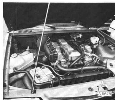
der Wasserpumpe mit Fünfblügel-Lüfter und dem Lufttrichter.
