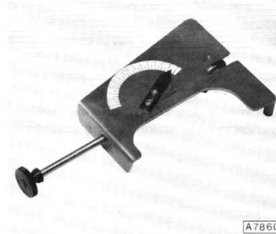
Die Prüfung der Spannung erfolgt am Leertrum – an der nicht belasteten Riemenseite. Das Prüfgerät ist am oberen Teil des Zahnriemens anzusetzen. Es darf jedoch nicht auf dem Nockenwellen-Antriebsrad aufsitzen.
