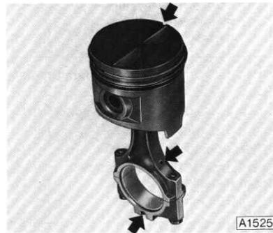
Kolbenbolzen mit Auspreßdorn von S-1297 und einer passenden Unterlage **kalt** auspressen. Kolben und Kolbenbolzen sind nicht mehr verwendbar.
