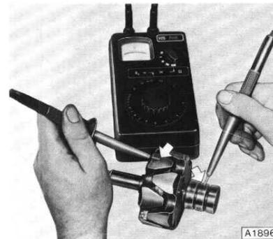
Läuferwicklung auf Windungsschluß (ohmschen Widerstand) prüfen.
