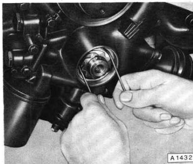
Sobald das Schraubenrad mit dem Zahnrad auf der Verteilerwelle nicht mehr im Eingriff ist, Verteilerfinger in dieser Stellung belassen.
