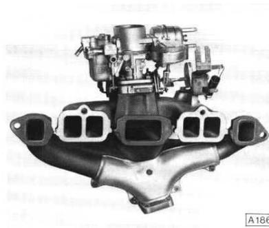
Krümmer-schrauben in gezeigter Reihenfolge wechselseitig auf 40 Nm (4 kpm/29 ft. lbs.) anziehen. Schrauben vorher mit kolloidalem Graphitfett bestreichen.
