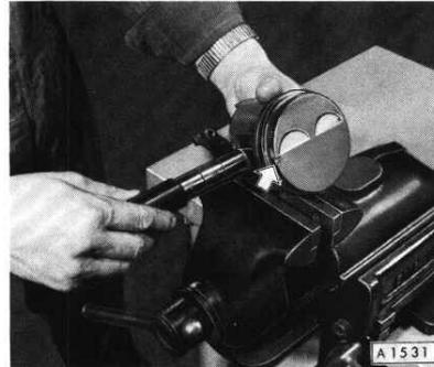
Das Einschieben des Kolbenbolzens in Kolben und Pleuelstange muß schnell und zügig geschehen, um vor dem rasch erfolgenden Abkühlen der Pleuelstange und damit verbundenen Festsitz des Kolbenbolzens den Montagevorgang bereits beendet zu haben. Ein festsitzender Kolbenbolzen kann ohne Risiko einer Kolbenverformung nicht mehr nachgedrückt werden.
