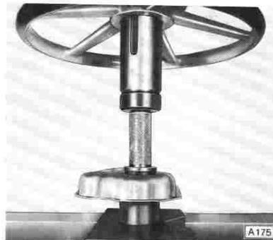
Dabei muß das in der Skizze gezeigte Maß  $X = 9 \text{ mm}$  (0,36 in.) eingehalten werden. Verdrehungshemmende Warzen an Deckel- und Dichtringeinfassung müssen dabei gleichmäßig zueinander versetzt sein. Steuergehäusedeckel einbauen. Ölstand prüfen.
