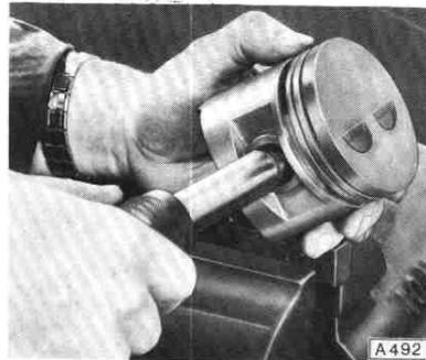
Kolben so über Pleuelauge führen, daß die vorstehend genannten Einbaumerkmale vorhanden sind, und Kolbenbolzen bis zum Anschlag des Einpreßdornes an den Kolbenmantel in Pleuelstange einschieben.
