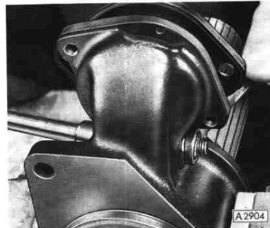
Anker mit Einrückhebel vom Antriebslager abnehmen.
