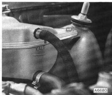
Der Renkverschluß am Ausgleichbehälter ist mit der Zahl "800" und einem "blauen Punkt" gekennzeichnet.
