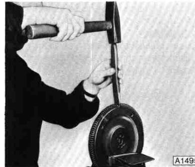
Neuen Anlasserkranz gleichmäßig auf 180 bis 230° C erwärmen (strohgelbe Anlauffarbe) und – Innenfase zum Schwungrad – mit Messingdorn gleichmäßig bis zur satten Anlage auftreiben.
