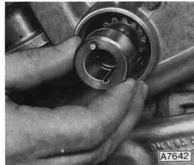
Am neuen Wellendichtring Dichtlippe mit Schutzfett einschmieren und auf das Zwischenstück aufstecken. Dichtring mit KM - 422 bis zum Anschlag einschlagen. Nockenwellenrad, Drehmoment achten, Zahn- riemen montieren, spannen und Wasserpumpe befestigen. Zahnriemenabdeckung montieren.
