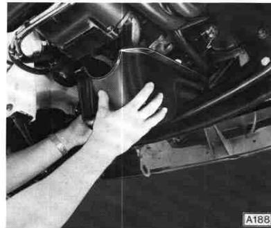
Dichtflächen von Motorblock und Ölwanne vor dem Wiedereinbau der Ölwanne reinigen und eine Raupe Dichtungsmasse (ca. 3 mm Ø/0,12 in.), Katalog-Nr. 15 03 294, an den nachstehend gezeigten Stellen auftragen:
