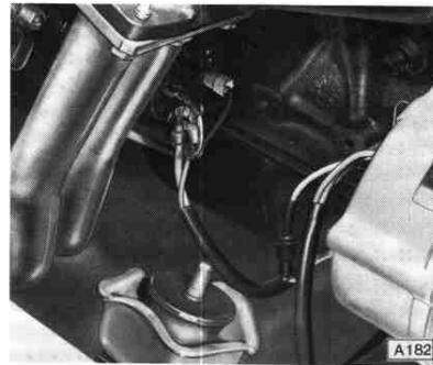
Bild zeigt Motoraufhängung am CIH-Motor.
