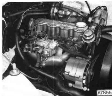
Oberen Kühlmittelschlauch entfernen. Auspuffrohr am Krümmer abbauen. Zündkerzenkabel abziehen und Klemme 1 abziehen.
