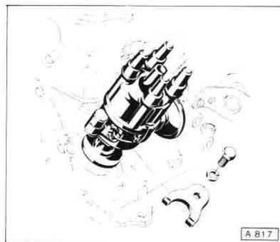
Bohrung im Steuergehäuse sofort mit einem Lappen abdecken, damit keine Fremdkörper in den Motor gelangen.
