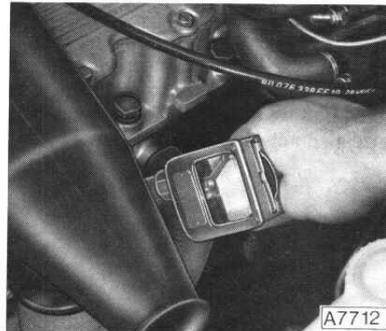
Bei Verdacht auf zu hohen Öldruck (Hydro-Stößel) ist dieser vor der Kompressionsmessung zu prüfen.
