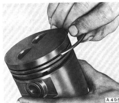
Beim Einbau darauf achten, daß »TOP«-Markierung am mittleren Ring (Minutenring) oben liegt und der Ringstoß gegenüber dem nächsten Ring um 180° versetzt ist.
