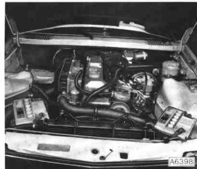
Jede Batterie ist mit einem Anhänger versehen, um beim Ab- und Anklemmen Kurzschlüsse zu vermeiden.
