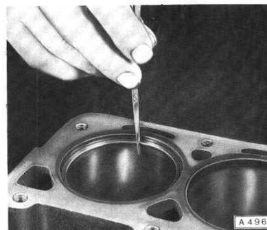
Zylinderschleif- und Kolbenmaße
