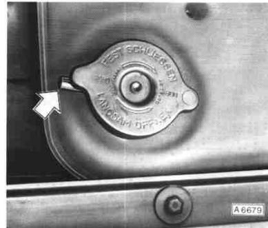
Die Einspritzanlage wird am Filter (Pfeil) und an der Einspritzpumpe durch Lösen der Verschlußschraube entlüftet.
