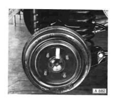
Falls erforderlich, Bremsbacken an den Nachstellexzentern so weit nach innen stellen, daß die Bremstrommel ohne Beschädigung der Beläge über diese hinweggeht.
