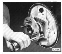
Hinterachswelle mit Montagewerkzeug SW-223 und SW-224 herausschlagen.
