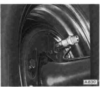
Schlauch des Prüfmanometers am Einsatzstück anschließen.
