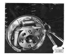
Bremsbacken-Federteller mit Montagewerkzeug SW-116 abnehmen.
