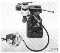
Beim Zusammenbauen Dichtungen, Innenseiten der Schutzkappen und Gleitflächen mit Bremszylinderpaste, Katalog-Nr. 1970500, oder Bremszylinderspray, Katalog-Nr. 1970501, einfetten.
