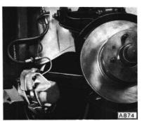
Bremsscheibe mit Vielzahn-Steckschlüssel MW-84 ab- und anschrauben.
