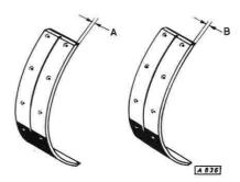
Beim Aufnieten der neuen Beläge in der Mitte beginnen. Bremsbacken an den Auflageflächen vorher gut reinigen, aber keine Klebstoffe oder ähnliche Mittel zwischen Bremsbacken und Belägen auftragen.
