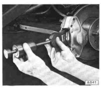
Kolben mit Kolbenrücksetzstange MW-108 einseitig wie gezeigt in Bohrung des Bremssattels hineindrücken.
