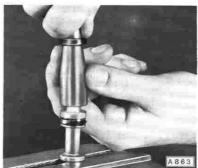
Die Kolben in Zylindergehäuse einbauen.
