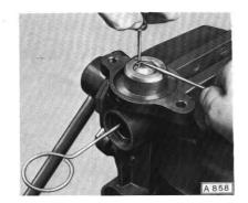
Kolben aus Gehäuse herausnehmen. Tandem-Hauptbremszylinder so auf eine Holzunterlage aufstoßen, bis der zweite Kolben herausgenommen werden kann.
