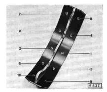
Bei Fahrzeugen mit 16 S-, 19 S- und 19 E-Motoren die Bremsbeläge so aufnieten, wie im nebenstehenden Bild gezeigt.
