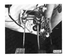
Beim Einbau des Pedalbockes ist die Sicherung am Kupplungspedal zu entfernen und das Kupplungspedal mit Rückzugfeder nach rechts zu schieben.
