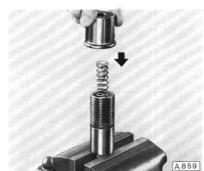
Kolbenfeder mit SW-118 zusammendrücken, bis der Sicherungsring in der Öffnung des Werkzeuges erscheint.
