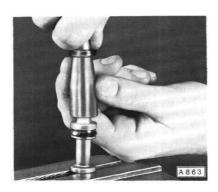
Zum Einschrauben der Anschlagschraube sowie zum Einsetzen der Sekundärmanschetten Montagenadel, wie beim Zerlegen, in Nachlaufbohrung des hinteren Kreises einstecken.
