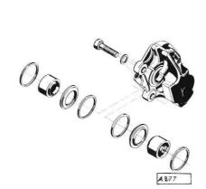
Klemmringe und Schutzkappen abnehmen. Kolben aus Flanschgehäuse mit Preßluft herauspressen.
