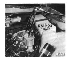
Vorderen und hinteren Bremskreis entlüften. Entlüftungsventile so lange offen lassen, bis klare, blasenfreie Bremsflüssigkeit ausfließt. Räder müssen dabei nicht abgenommen werden.
