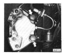
Bremssattel mit einem Drahthaken aufhängen. Radnabenkappe mit Abzieher S-1257 abziehen. Vorderradnabe mit Bremsscheibe aus- und einbauen.
