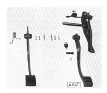
Pedalbockwelle und Lagerbuchsen mit Molybdändisulfidpaste, Katalog-Nr. 1948 524, einfetten.
