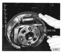
Bremsbacken mit Bremsbackenhebel aus Handbremsseil aushängen. Beide Bremsbacken abnehmen.
