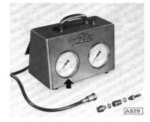
Der gesamte Einsatz ist anstelle des Entlüftungsventils in einen Radbremszylinder der Hinterräder einzuschrauben. Die Umgebung des Entlüftungsventils muß dabei gut gesäubert sein.
