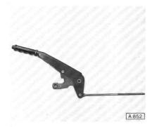
Zahnsegment und Zahnklinke leicht mit Molybdändisulfidpaste, Katalog-Nr. 1958524, einfetten.
