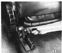
Teppichboden zurückschlagen und beide Handbremshebel-Befestigungsschrauben abschrauben. Handbremshebel aus Halterung etwas herausziehen und Handbremskontrollschalter abschrauben. Handbremshebel herausnehmen.
