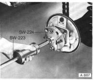
Zusammenbau in umgekehrter Reihenfolge. Handbremsseil im Bereich der Führungen mit Spezial-Schmiermittel, Katalog-Nr. 1948482, einfetten. Bremsträgerplatte im Bereich der Papierdichtung mit Dichtungsmittel, Katalog-Nr. 1504 200, bestreichen. Neue Papierdichtungen auf Bremsträgerplatte innen und außen aufkleben.
