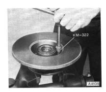
Bremsscheibe mit Radnabe zusammenbauen.
