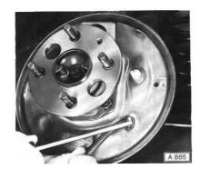
Bremsträgerplatte vom Hinterachstragrohr abschrauben.
