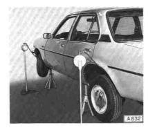
Die Kennzahl des Bremskraftreglers ist im eingebauten Zustand mit einem Spiegel festzustellen. Sie ist bei allen Fahrzeugen, die damit ausgestattet sind, 35. Folgende Fahrzeuge sind mit einem Bremskraftregler versehen:
