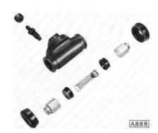
Einzelteile mit Bremsflüssigkeit oder Spiritus reinigen, keinesfalls andere Flüssigkeiten verwenden.
