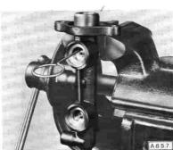
Sicherungsring unter Verwendung von zwei Schraubenziehern entfernen. Vorsicht, Kolben und Zylinderwandung nicht beschädigen!
