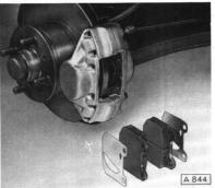
Nach dem Einbau der Bremsbeläge Bremspedal mehrmals vollständig durchtreten, damit sich die Kolben in den Bremssätteln auf kleinstes Lüftspiel einstellen. Bremsflüssigkeitsstand im Ausgleichbehälter richtigstellen.
