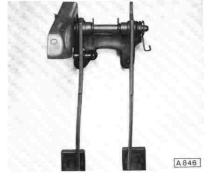
Für die Steuerung des Bremskraftverstärkers Bremspedal so einstellen, daß ein fühlbares Spiel von ca. 6 bis 9 mm (A 866) vorhanden ist (an Bremspedalplatte gemessen). Rückzugfeder für Bremspedal einhängen.
