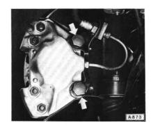
Bei Bremssätteln, die mit Bremsbelägen geliefert werden, sind die Sicherungsstifte, Spreizfedern und Bremsbeläge vor dem Einbau zu entfernen. Vor dem Einbau der Bremssättel sind die Kolben auf ihre Beweglichkeit zu überprüfen. Dazu sind die Kolben mit der Kolben-Drehzange Nr. 3.9314–1500.2 (siehe unter »Spezial-Werkzeuge« in dieser Gruppe) geringfügig in beide Richtungen zu drehen.
