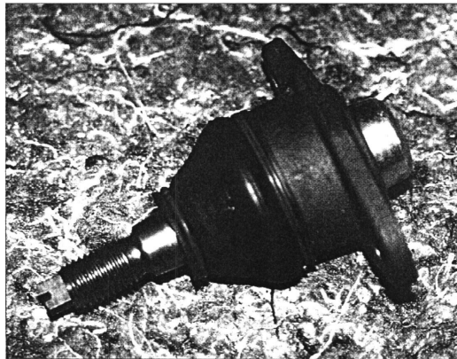
Das Exzenterführungsgelenk. Die Einstellung wird im eingebauten Zustand mit einem 8er Schlüssel an dem Vierkant vorgenommen.
